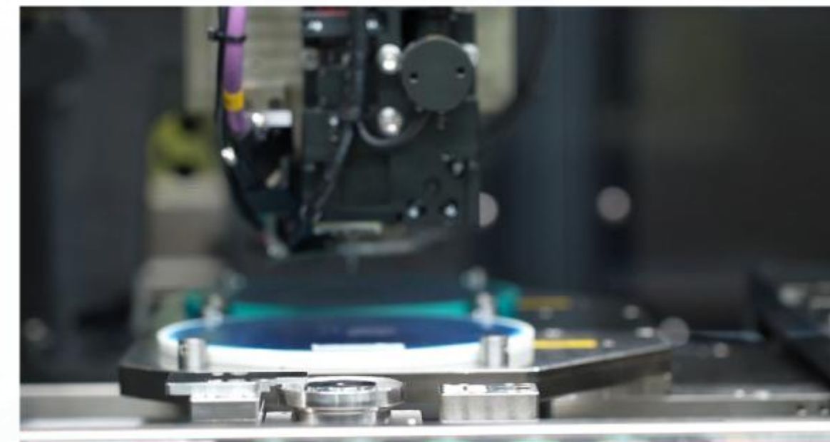
半导体 倒装固晶机 Semiconductor flip cementing machine
