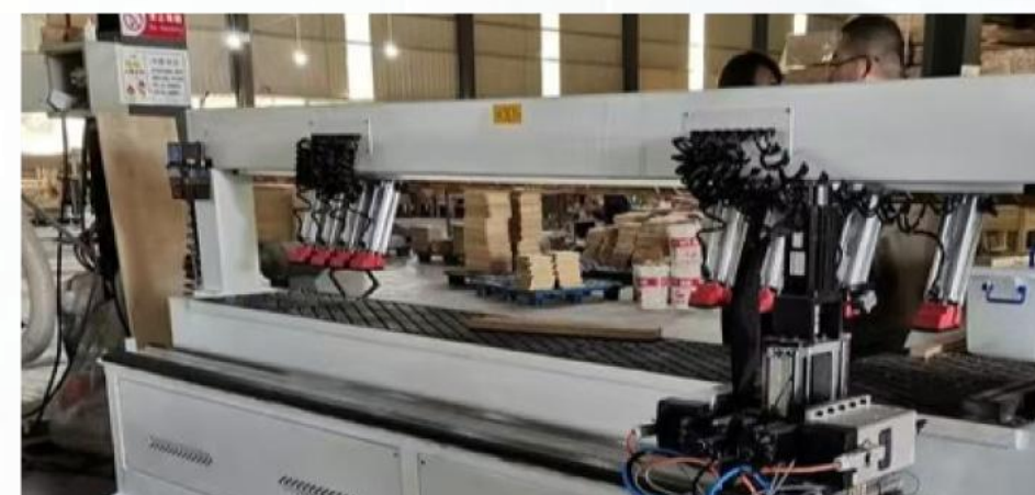
木工行业 木工侧孔机 Woodworking side hole machine
