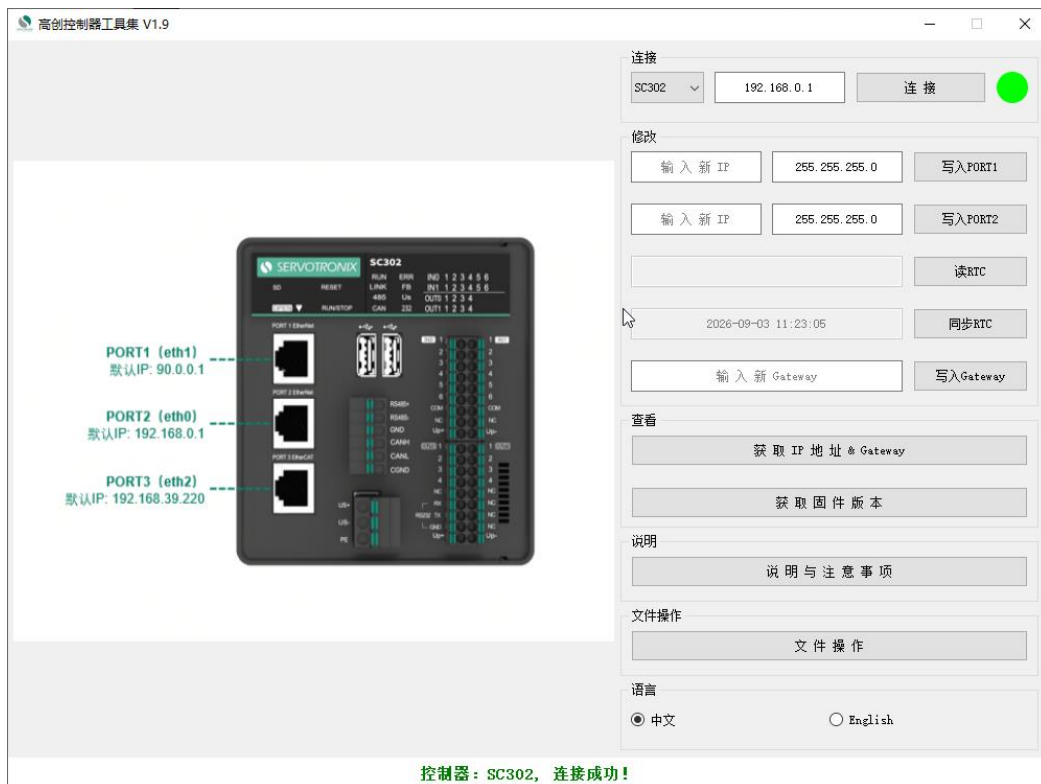
图 12-1 高创控制器工具集软件中文界面
