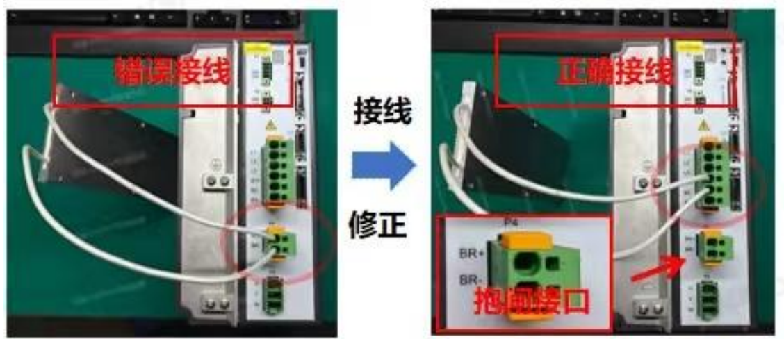
图 4-45 再生电阻与 B1+ 和 B2 连接
