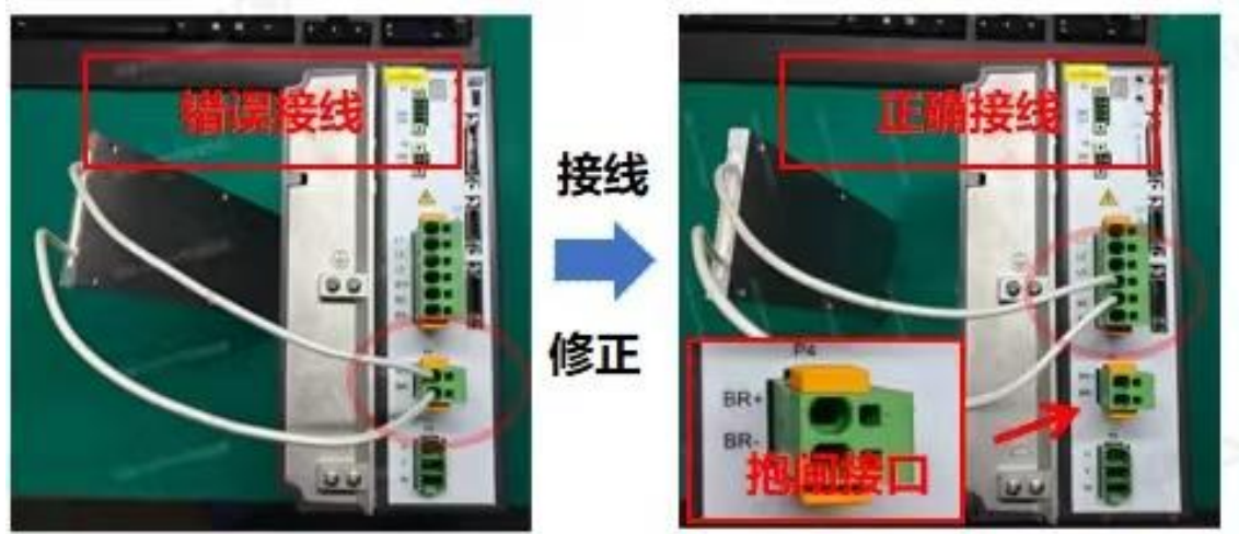
图 4-45 再生电阻与 B1+ 和 B2 连接
