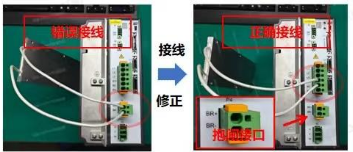
图 4-45 再生电阻与 B1+ 和 B2 连接
