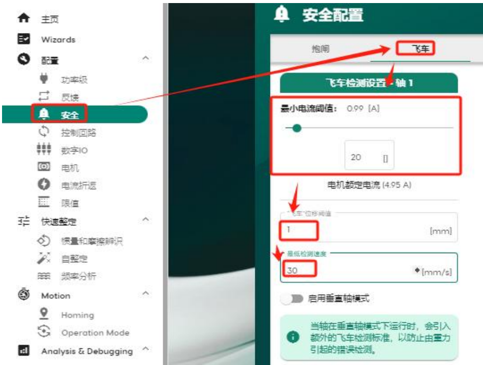
图 7-11. 电机飞车检测
