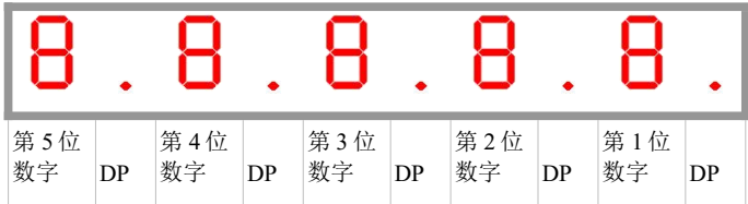
图 8-1 5 位数字 LED 显示屏面板
