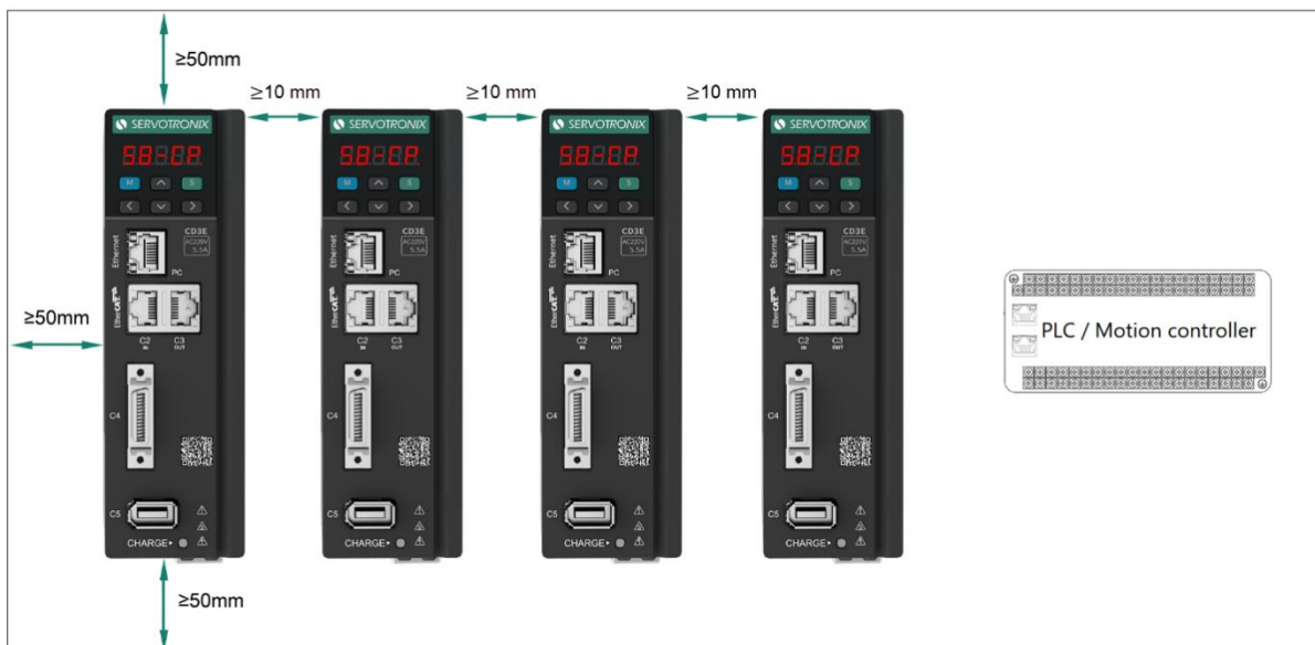
图 4-1 在机柜内安装多个 CD3E 单元
