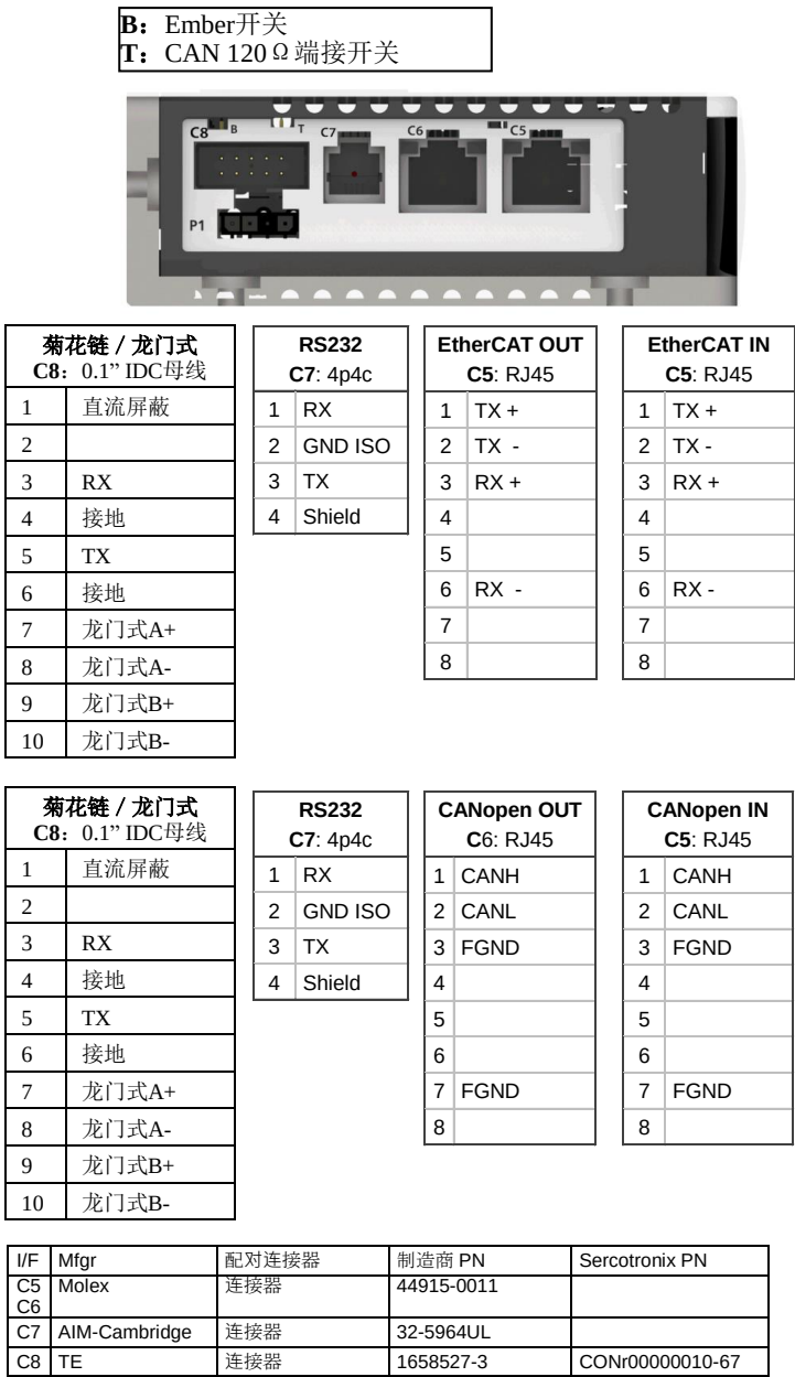
图 4-17. CDHD2（低压）控制板引脚分配 - 上面板
