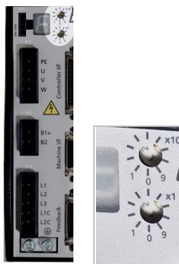
图 5- 13. 驱动器地址旋转开关
