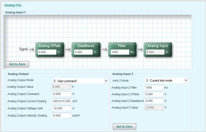
图 6-17. 模拟输入 2 作为电流限制器
