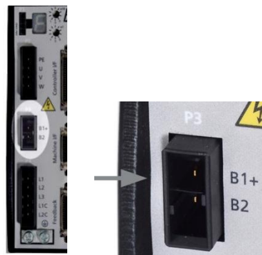
图 5- 16. 再生电阻接口 (此图型号 CDHD-006)
