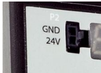
图 5- 20. 24V 逻辑电源输入接口
