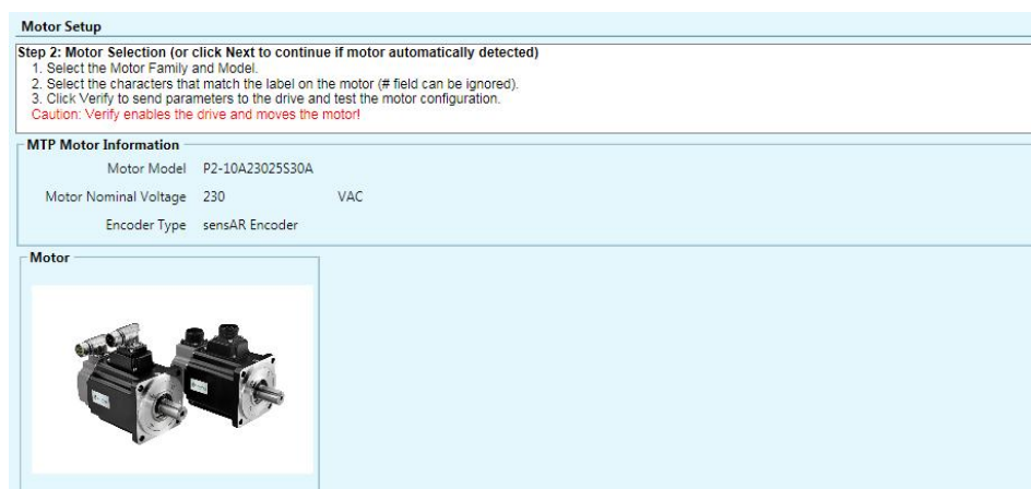
图 7-2. ServoStudio – 电机设置向导 - 示例 1
