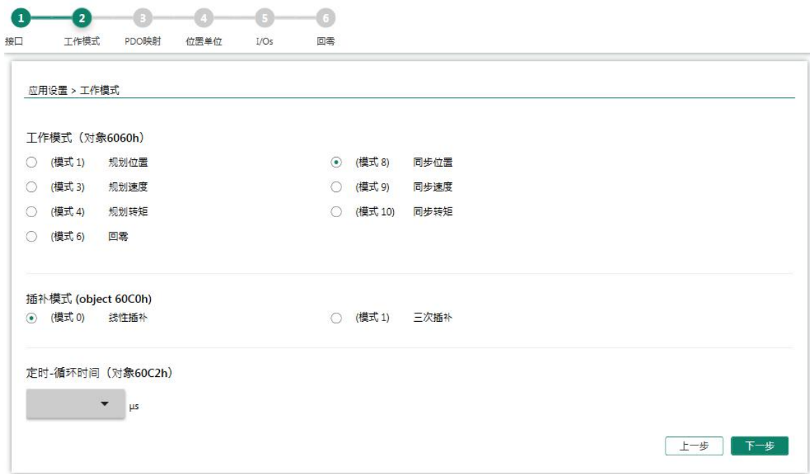
图 7-2 ServoStudio 2 - 应用程序设置向导 - 操作模式 (EtherCAT)
