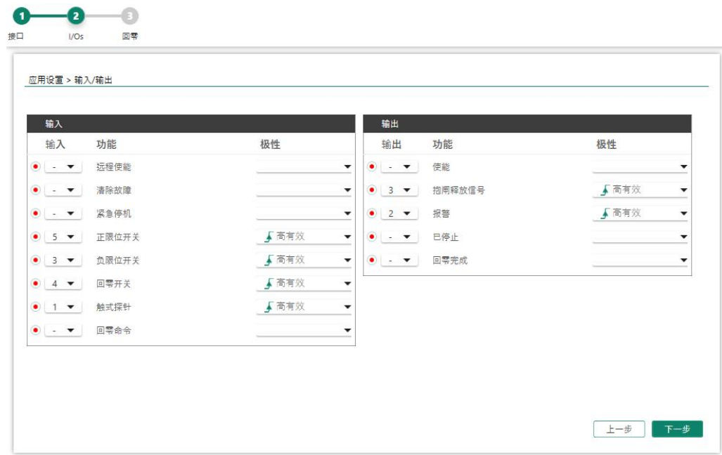
图 7-4 ServoStudio 2 - 应用程序设置向导 - 输入/输出
