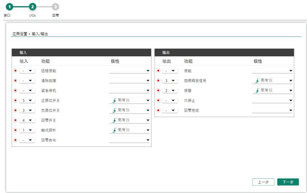
图 7-4 ServoStudio 2 - 应用程序设置向导 - 输入/输出
