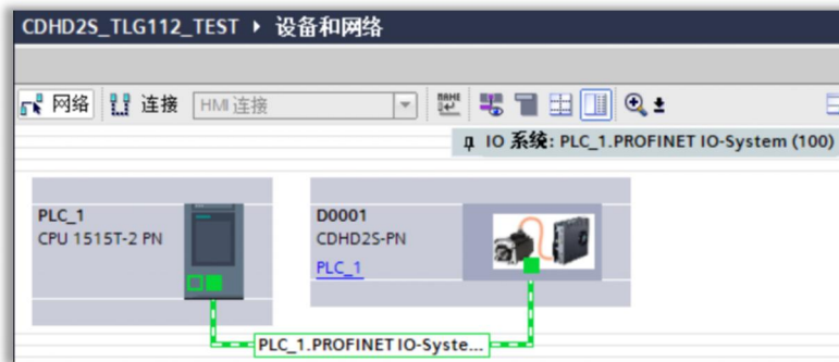
图 9-17 在网络视图添加 PLC 和高创 CDHD2S-PN 驱动器 在安装高创 CDHD2S-PN 最新的 GSDML 文件后为驱动器添加西门子 112 报文
