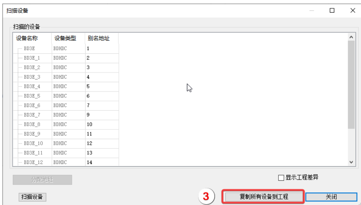
图 7-8 复制所有设备到工程
