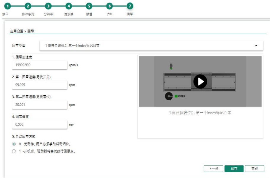
图 6-5 图 6-5 ServoStudio 2 - 应用程序设置向导 - 回零
