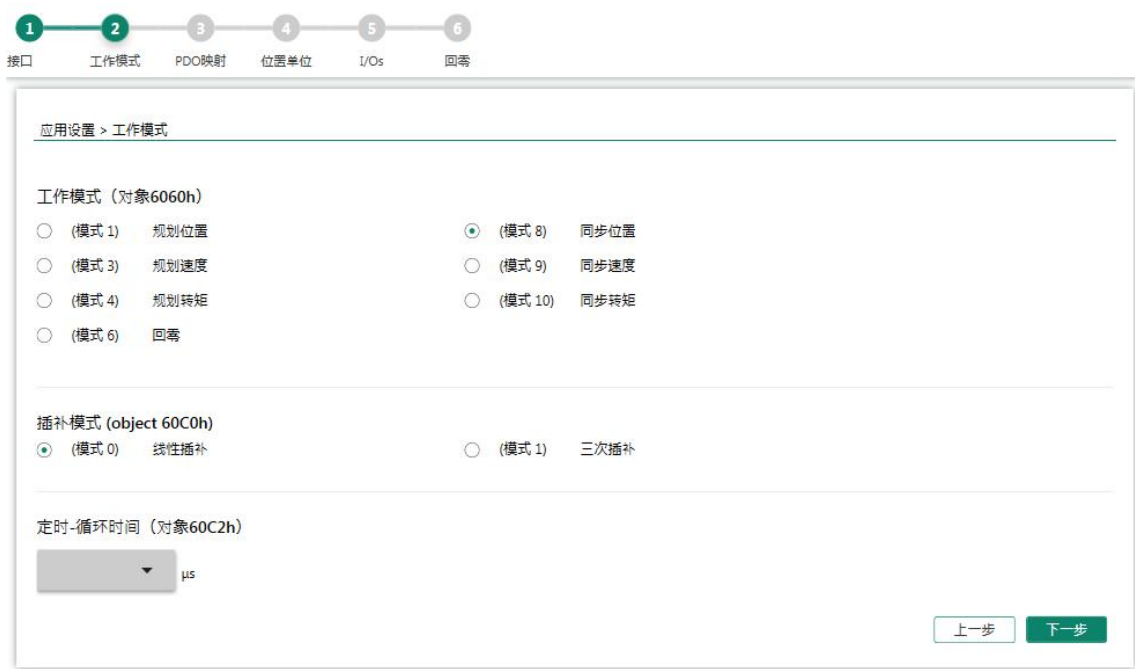
图 6-2 ServoStudio 2 - 应用程序设置向导 - 操作模式
