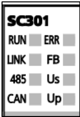
图 4-4 系统状态指示灯
