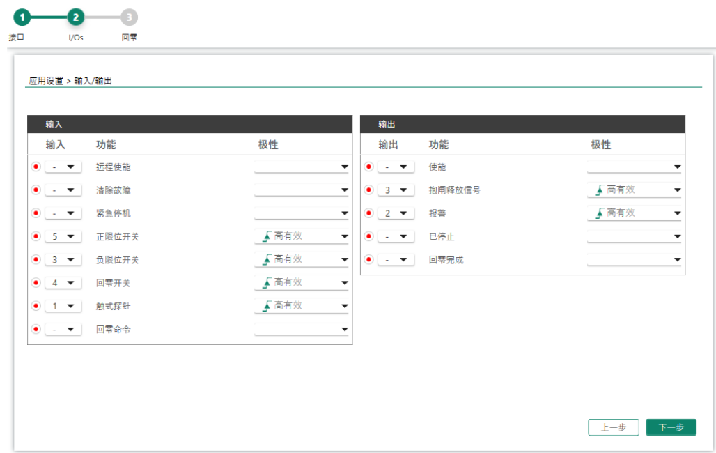
图 6-4 ServoStudio 2 - 应用程序设置向导 - 输入/输出
