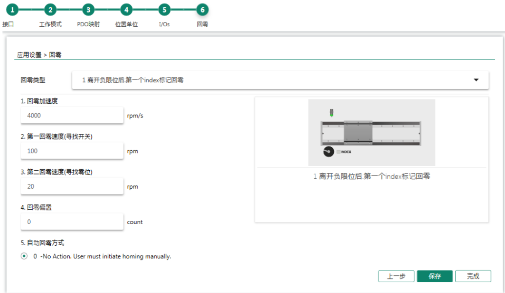
图 6-5 ServoStudio 2 - 应用程序设置向导 - 回零
